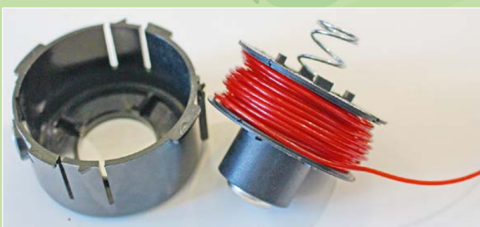
Длина лески в полуавтоматической катушке – 6,5 м
