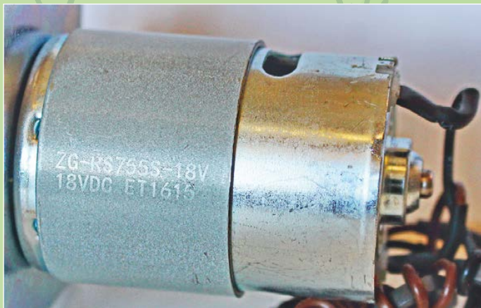
Двухполюсный, высокооборотистый щёточный 18-вольтовый двигатель ZG-RS775S-18V
